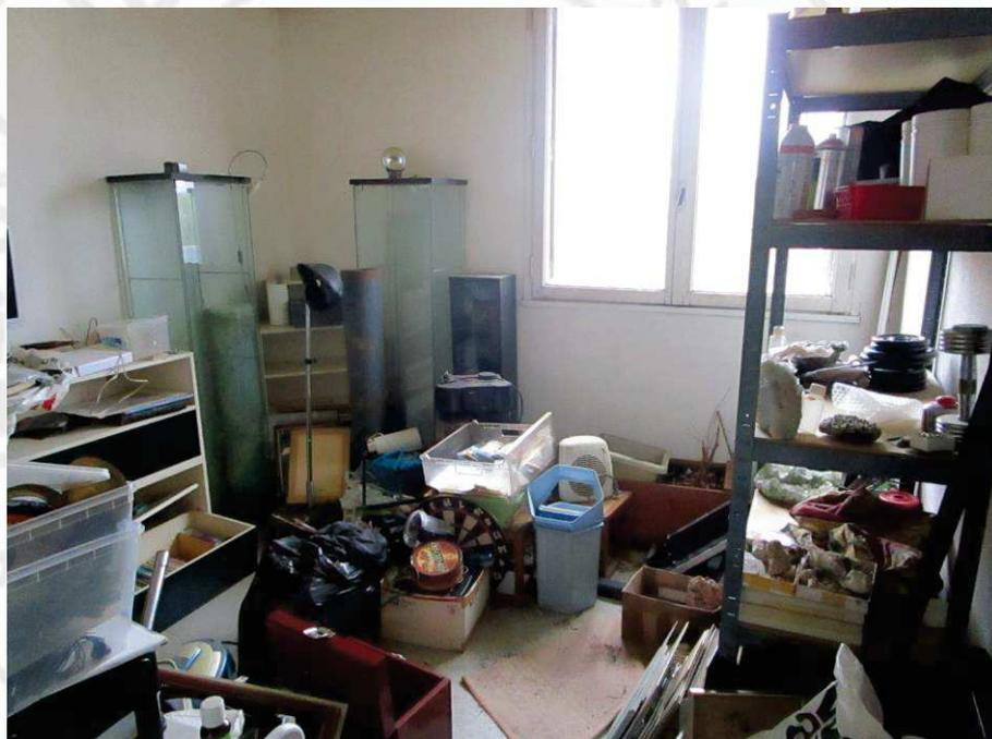
La pièce comporte une baie vitrée, deux pans ouvrants, châssis bois simple vitrage, peinture usagée ; la baie est sécurisée par des volets pliants bois hors d'usage.
